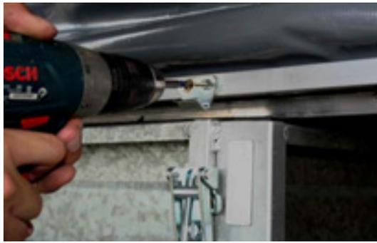
Befestigen Sie die Schnappverschlüsse mit Bohrschrauben am Anhänger und den Stahlstreben des Zeltrahmens.
