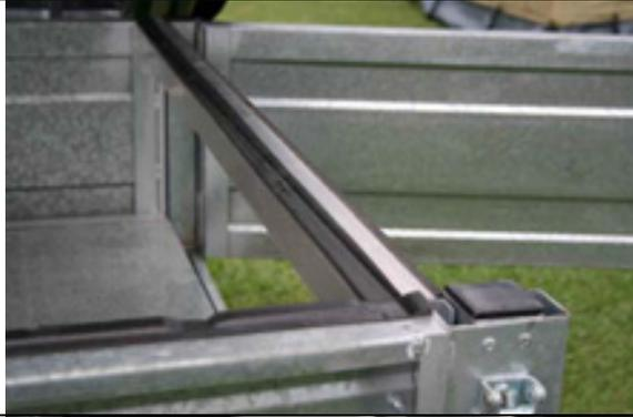
Zusätzliche Streben oder Trennwände können direkt an den Anhängerwänden befestigt werden.
