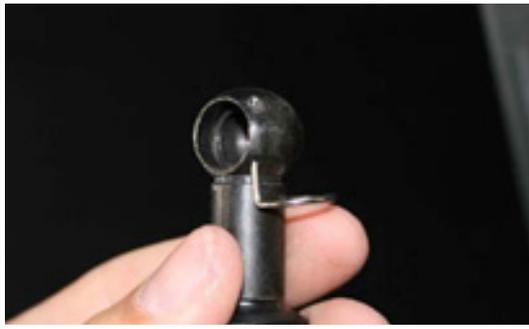
Der Sicherheitsstift wird mit einer leichten Drehbewegung entriegelt und kann dann nach unten ausgezogen werden.
