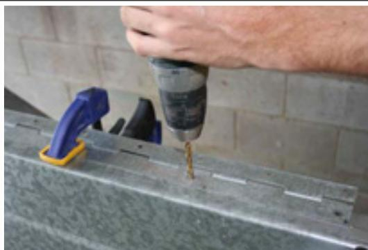
Bohren Sie Löchern mit maximal 10cm Abstand durch das Scharnier und die Seitenwand Ihres Anhängers. Die Lochgröße muss Ihren Niete, die Sie später zur Fixierung benutzen, angepasst sein.
