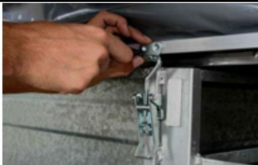
Die Schnappverschlüsse sollten an beiden Ecken (gegenüberliegende Seite des Scharniers) angebracht werden um das Zelt zu schließen und während der Fahrt zu sichern.
