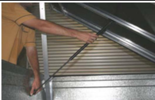
Die Gasdruckfedern werden an der Anhänger-Innenwand und dem Stahlrahmen des Zeltes befestigt. Die Zylinder müssen hierbei nach oben zeigen und in einem Winkel angebracht werden, der es erlaubt das Zelt zu heben und in Position zu halten. Wir empfehlen die Gasdruckfedern in einem Winkel von ca. 42Grad bei geöffneten Zelt zu montieren.
