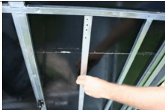
Sektionen, in denen der Zeltrahmen nicht direkt auf den Anhängerwänden aufliegt, können mit 2cm dicken Stahl, Aluminium oder Holzleisten bestückt werden.
