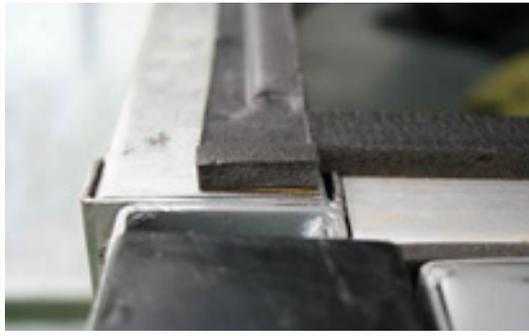
Verwenden Sie die Schaumstoffdichtung um das Zelt mit dem Anhänger rundum wasser- und staubdicht zu versiegeln.
