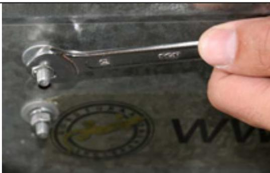
Verschrauben Sie die Winkel an den Anhängerwänden mit passenden Schwerlastschrauben, Beilagscheiben und Splittings.
